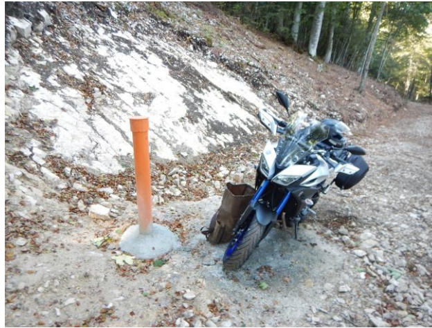
Forage équipé d'un tube piézométrique pour la mesure des niveaux d'eau
